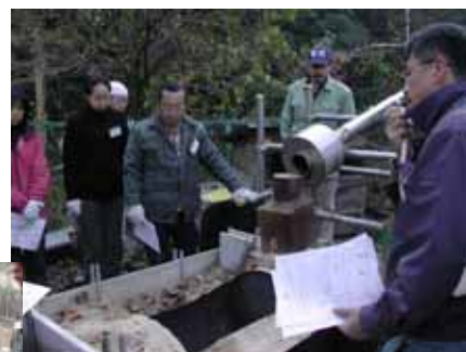
これが、ドラム缶高速炭やき窯です。なかなかすぐれもので、木酢液も採れます。
